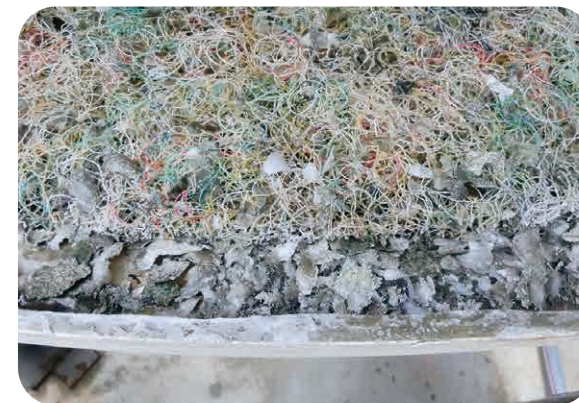
充填材から剥離したスケール片がマットに落ちた
