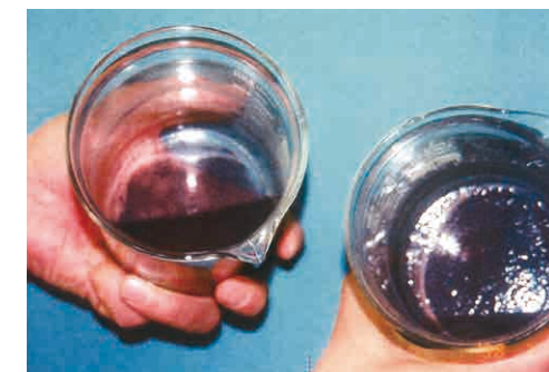
左：SW処理サラサラ 右：未処理岩のり状に付着
