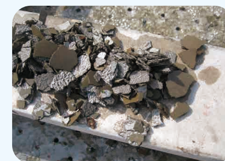
剥離物の茶色部分は配管に付着した面で白色は水側
