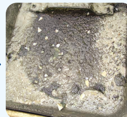
SW稼働9ヶ月後 上部皿部に軟化スケールが多量に堆積されたため 袋に回収する作業を行った
