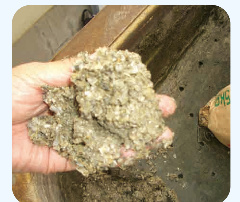
SW稼働9ヶ月後 上部皿部に軟化スケールが多量に堆積されたため 袋に回収する作業を行った
