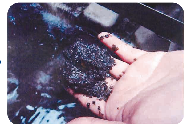
CT底部に軟化剥離物が多量に排出された
