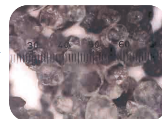
より球体が大きくなり分離しやすくなる（100～150μm）
