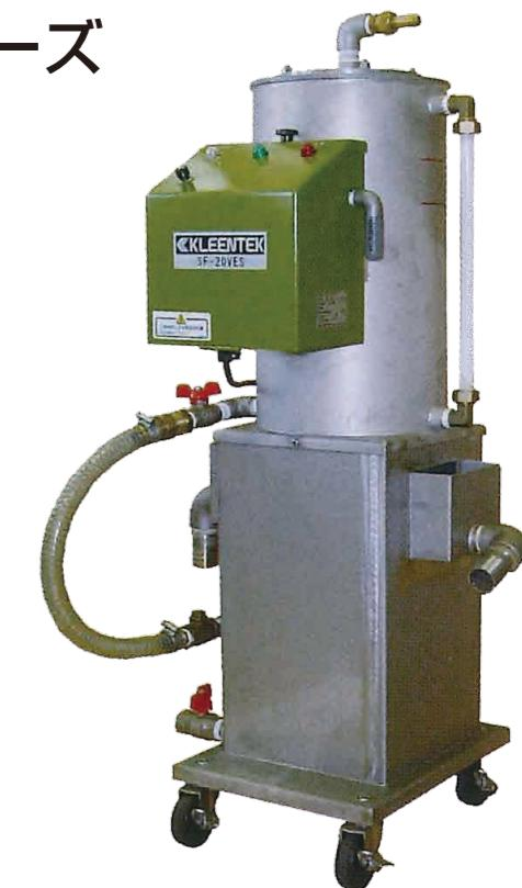
機械装置液槽の浮上油を回収：効果を計量証明で確認
